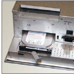
Trappe pour disque dur, maintenance facile
