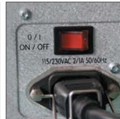
Anti-traction sur le câble d'alimentation
