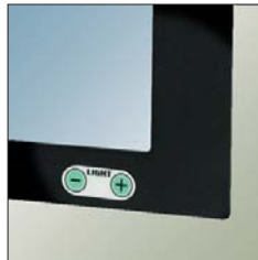
Bouton de réglage luminosité en face avant
